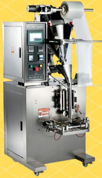
ماكينة تعبئة وتغليف اكياس بودرة سكرو Automatic screw powder filling machine
